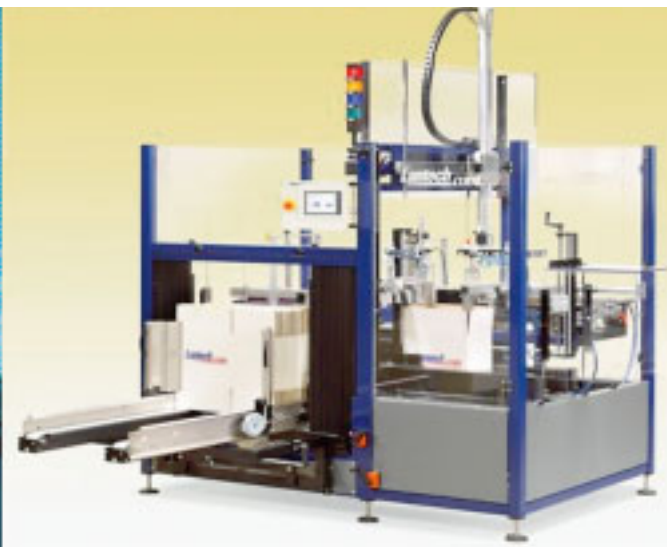
Pahvilaatikoihin pakkaaminen voidaan automatisoida Lantechin Case Packer-koneilla. Laatikonmuodostaja avaa pahvilaatikon, asettaa tuotteet sisään, sulkee ja teippaa pakkauksen, kertoo Jaakko Laihorinne.
