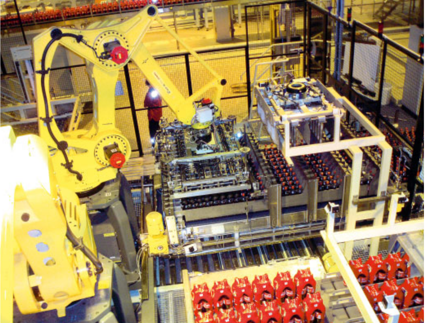
Juomateollisuuden lavausjärjestelmä asettaa irtopullot alustalle ja ryhmäpakkaukset lavalle. Robottisolussa voi olla yhden aitauksen sisällä jopa 5 robottia, jotka toimivat samanaikaisesti.
